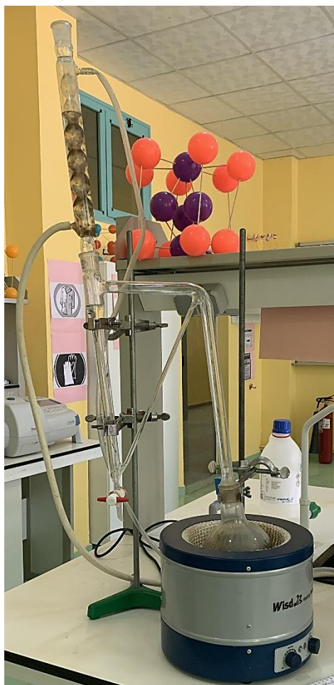
Figure 26 : Extraction d'huile essentielle Moringa oleifera avec l'appareil Clevenger (Prise le 07/06/2021)
