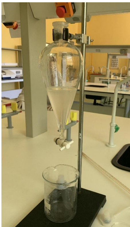
Figure 38 : Phase de séparation l'huile végétale de le solvant ( Prise le 09/06/2021 )
