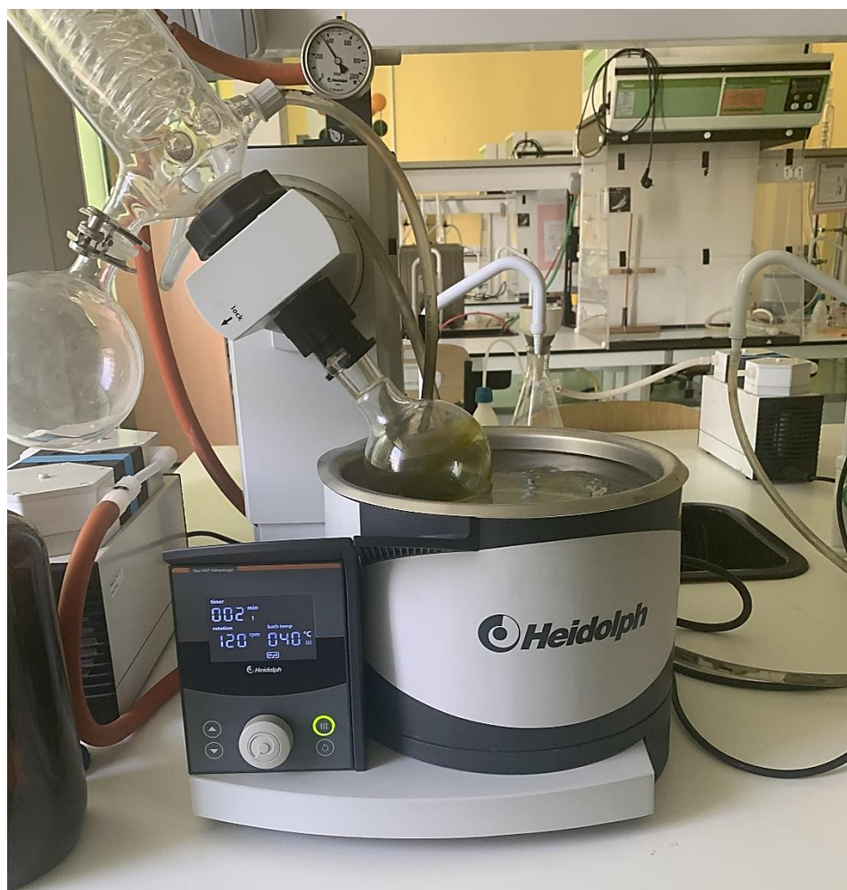
Figure 24 : un séchage de l'extrait avec l'appareil rotavapor (Prise le 17/05/2021)
